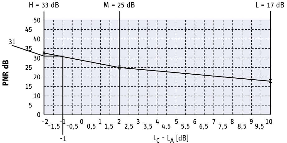
Bild 11: Graphische Bestimmung der vorhergesagten Minderung des Geräuschpegels (PNR) nach HML-Methode
