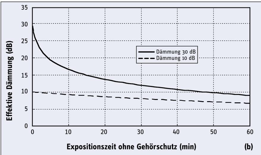
Bild 9: Effektive Dämmung eines Gehörschützers mit 30 bzw. 10 dB Dämmung in Abhängigkeit von der Expositionszeit ohne Gehörschützer bezogen auf eine 8-Stunden-Schicht (Bild (a): Zeitraum 8 h, Bild (b): Zeitraum 60 min).
