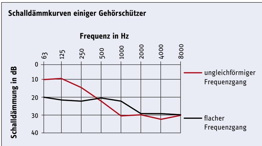
Bild 6: Schalldämmkurven typischer Gehörschützer
