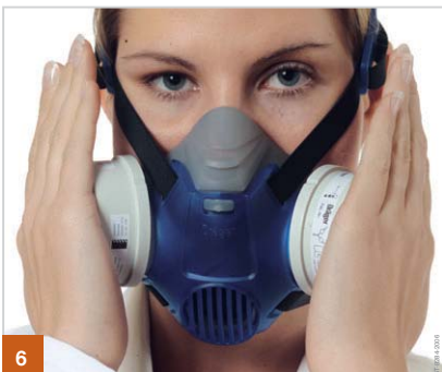
6 Unterdruckprüfung: Beide Filter mit den Händen dichthalten und einatmen, bis Unterdruck entsteht, Luft kurzzeitig anhalten. Der Unterdruck soll bestehen bleiben. Sonst Maske zurechtrücken und Bänder nachziehen oder andere Größe verwenden. Prüfung wiederholen bis Maske dicht sitzt.
