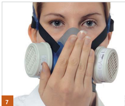
7 Überdruckprüfung: Ausatemventil dichthalten und einmal kräftig ausatmen. In der Maske baut sich kurzzeitig ein leichter Überdruck auf. Falls Luft über den Dichtrahmen abströmt, Maske zurechtrücken und Bebanderung nachziehen oder andere Größe verwenden. Prüfung wiederholen bis Maske dicht sitzt.
